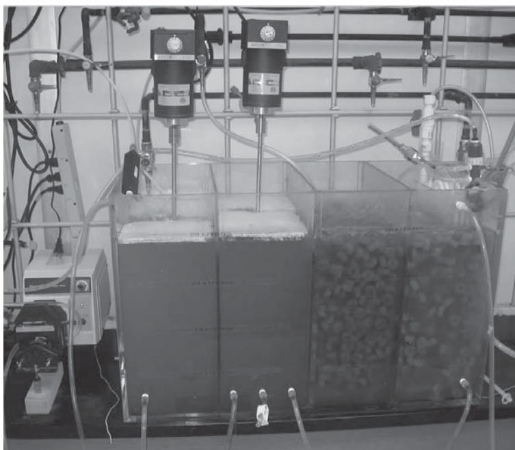
شکل ۶: نمونه از سیستم IFAS
