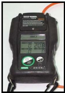
قبل از آنکه فرد بتواند وارد فضای بسته شود، اکسیژن موجود در هوای داخل ظرف یا فضای بسته باید توسط دستگاه آزمایش گاز، اندازه‌گیری شود. گازهای قابل اشتعال و انفجار همچنین گازهای سمی موارد دیگری هستند که باید در هوای محیط محصور اندازه‌گیری شوند و در صورت وجود شرایط ایمن، اجازه ورود صادر شود.
